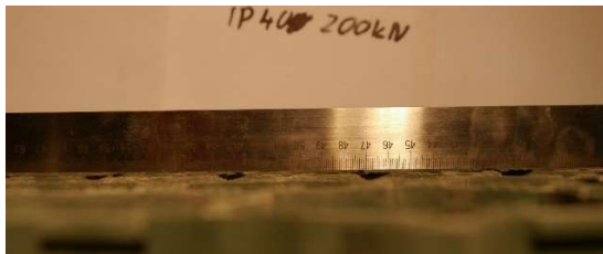
Fot. 5. Krata IP 40 po obciążeniu 200 kN
