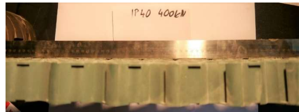
Fot. 6. Krata IP 40 po obciążeniu 400 kN
