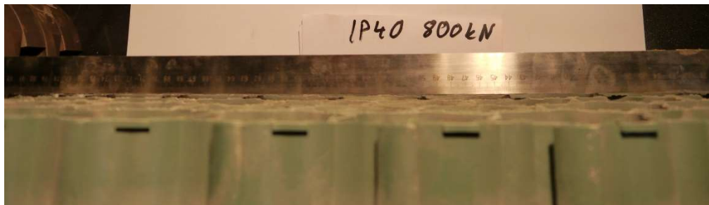
Fot. 7. Krata IP 40 po obciążeniu 800 kN
