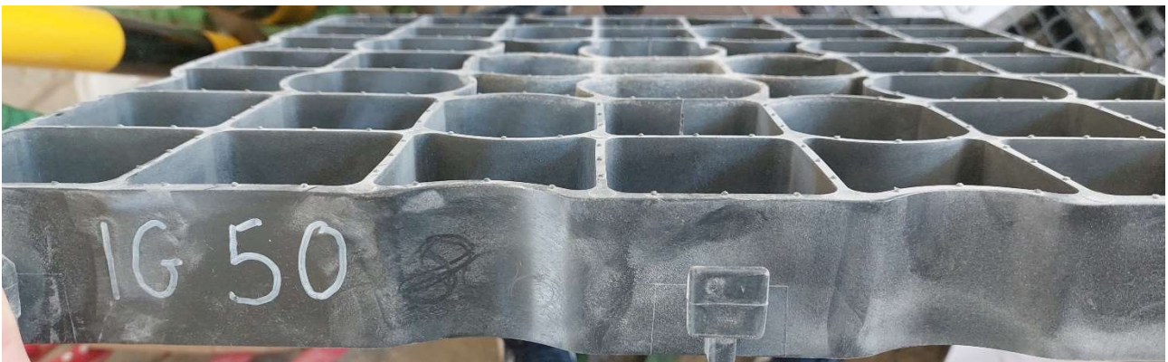
Fot. 7. Krata IG 50 po obciążeniu 800 kN
