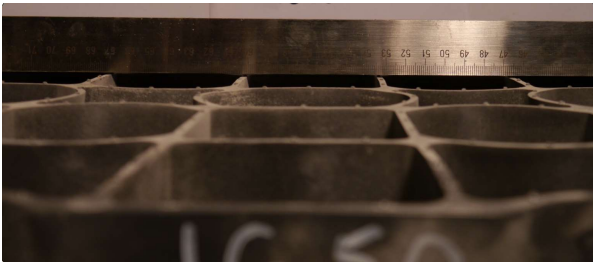
Fot. 3. Krata IG50 po obciążeniu 57,5 kN
