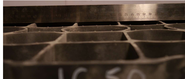
Fot. 4. Krata IG 50 po obciążeniu 80 kN
