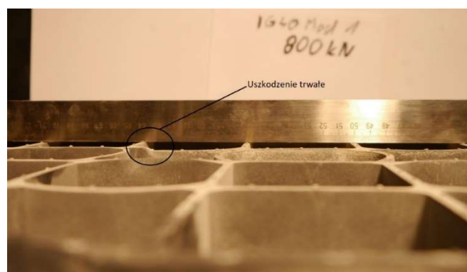
Fot. 7. Krata IG 40 Mod 1 po obciążeniu 800 kN z opisem uszkodzeń
