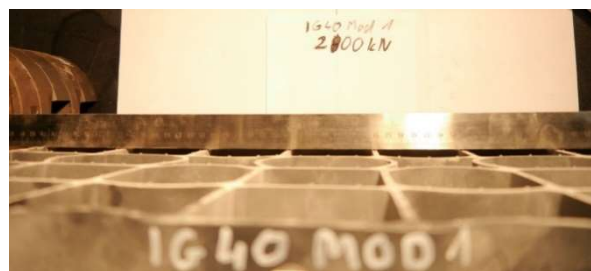
Fot. 5. Krata IG40 Mod 1 po obciążeniu 200 kN
