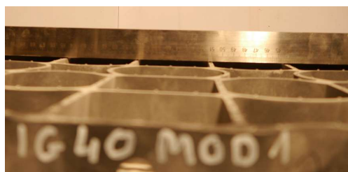
Fot. 3. Krata IG40 Mod 1 po obciążeniu 57,5 kN
